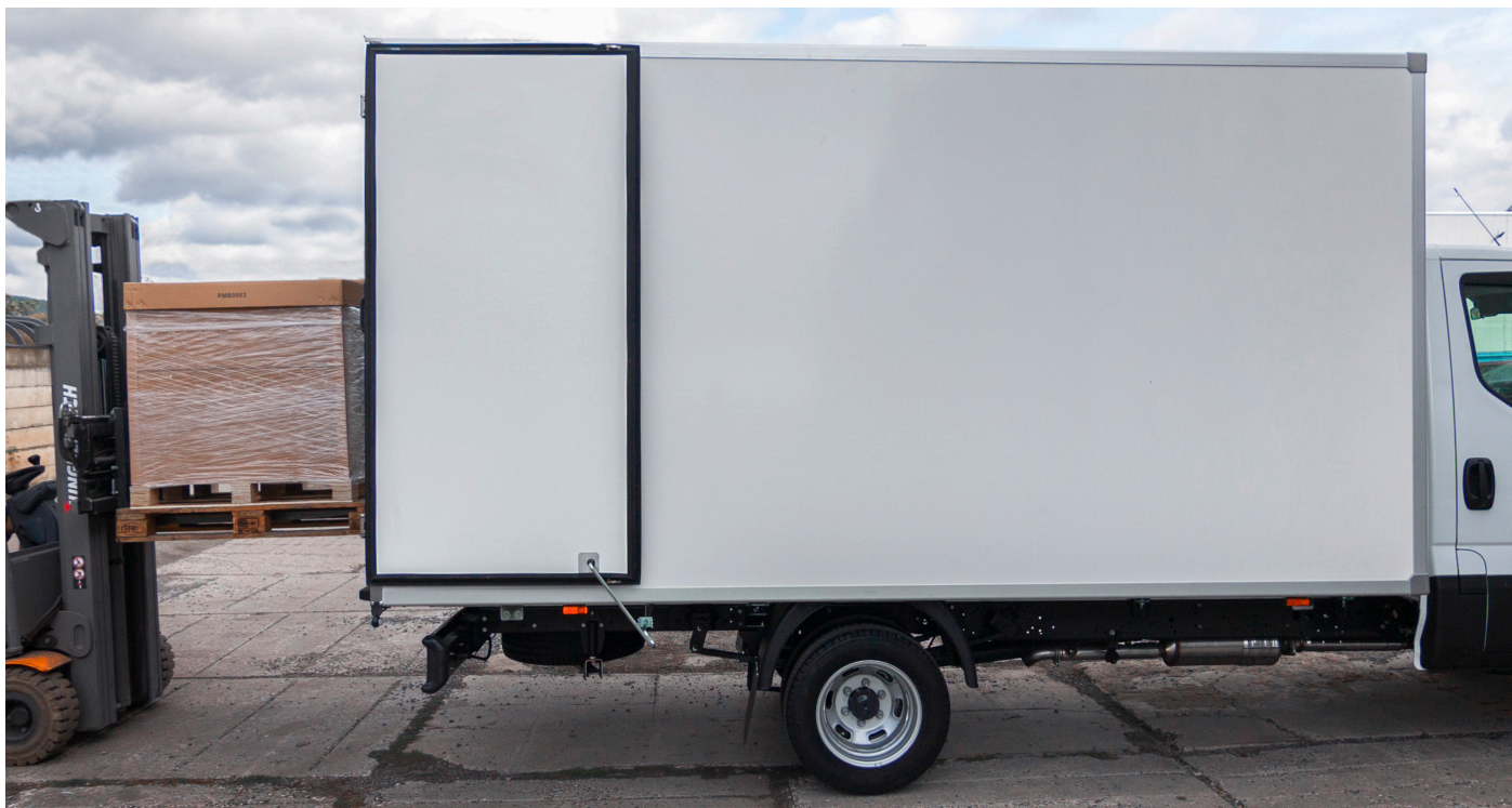
Varianta „8 paleta“ bez bočních dveří – hmotnost od 350 kg.
